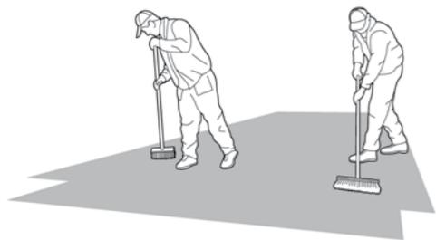
**1** Antes de instalar el pavimento deje climatizar las losetas unas 24 horas, rectifique y barra el suelo base.
